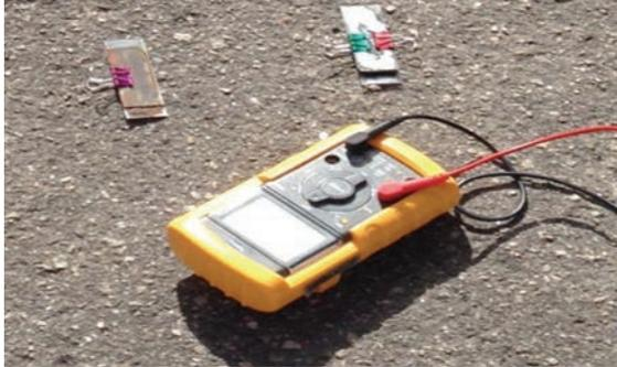
O dióxido de titânio, formando o eletrólito negativo, é o “fornecedor” de elétrons, enquanto o eletrólito positivo, constituído de grafite, é o “receptor” de elétrons. Com o dispositivo montado na Figura 3 esperava-se que fosse identificado uma quantidade de corrente suficiente para ligar uma luz de LED, o que não foi possível, ainda.
