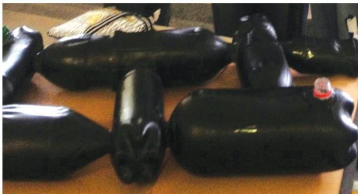
Além de não precisar de reservatório térmico outro grande diferencial sobre os aquecedores convencionais é que o dispositivo que construímos baseia-se no “Princípio dos Diferentes Tamanhos de Garrafas”, como chamamos. Nessa perspectiva, pode-se aquecer um volume de água suficiente para um banho, se considerarmos uma célula de poucas garrafas, mas a uma temperatura igual ou maior que o banho em chuveiro elétrico.
