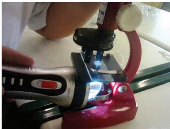
Também foi feita uma análise da água com um “microscópio caseiro”. Esse microscópio baseia-se na incidência de raios laser verde, que incidindo numa gota de água faz aparecer imagens de micro-organismos em água contaminada. A Figura 4 abaixo mostra o experimento.
